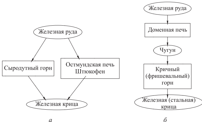
Рис. 3.8. Схемы производства железа: а – одностадийная; б – двухстадийная
