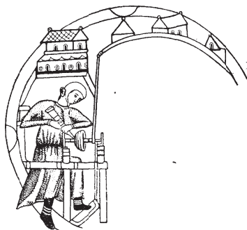
Рис. 2.38. Токарный станок с очепом и ножным приводом. XIV в. Французская миниатюра
