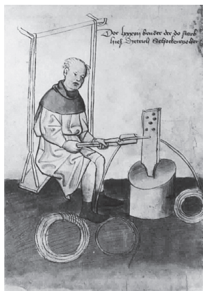
Рис. 2.37. Волочение проволоки на приспособлении с качающимся сиденьем, около 1418 г.
